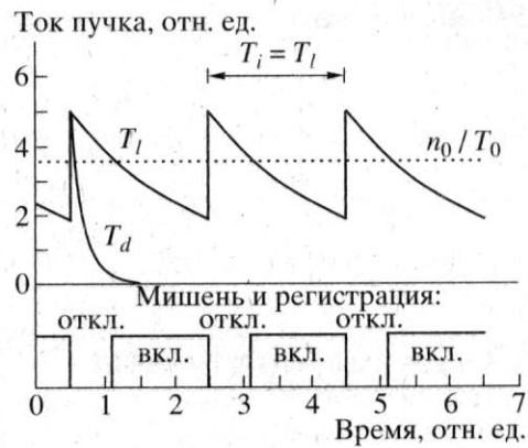
Рис. 1. Типичный цикл работы накопительного кольца с внутренней мишенью в сверхтонком режиме: T_0 — период обращения пучка электронов, T_l — время жизни пучка, T_i — период инъекции, T_d — время затухания колебаний пучка, n_0 — число электронов в импульсе инъекции.
