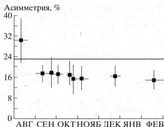
Рис. 3. Асимметрия в упругом электрон-дейтронном рассеянии, измерявшаяся при наборе данных на накопителе ВЭПП-3. Сплошная линия — вычисленная величина асимметрии при степени тензорной поляризации P_{zz} = 1 .
